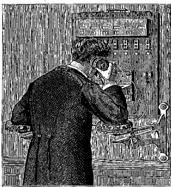
Fig. 54. — Poste téléphonique muni d'accoudoirs Lhoste.
